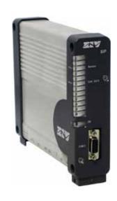
El SIP-5 es un nodo diseñado para operar como router WAN y como encapsulador serie a IP
