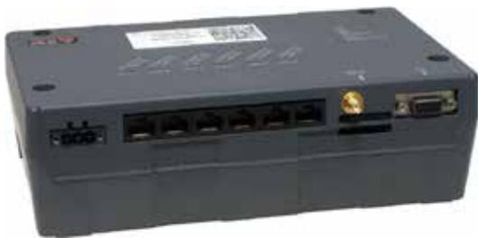
El **EMR-2** es un **router** diseñado para proporcionar **conectividad a nivel de la capa 3** utilizando las redes inalámbricas públicas
