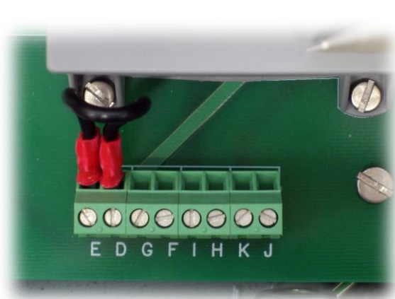
Figura 5 Puentes de selección de la impedancia nominal lado equipo
