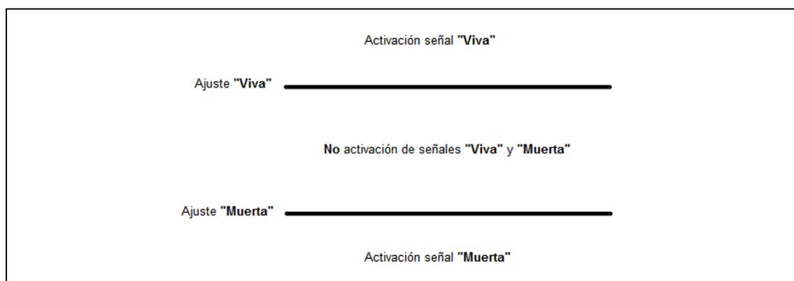
Figura 3.22.6: Umbrales de activación para determinar Línea Viva / Línea Muerta y Barra Viva / Barra Muerta.
