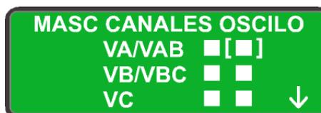
La máscara se modifica (en la línea señalada con los corchetes) mediante las teclas 1 (activación) ó 0 (desactivación).
