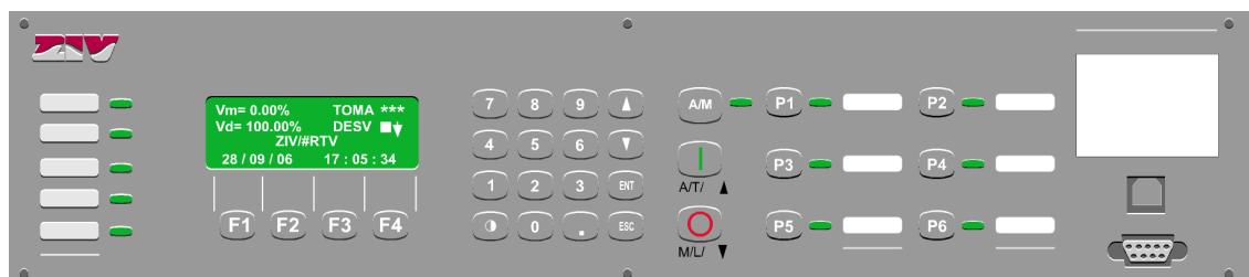
Figura 2.3.1: Frente de un 6RTV de 2U de altura.
