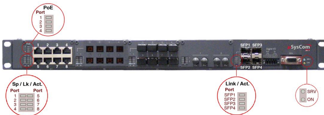
FIGURA 20 Detalle de los distintos LEDs en el SWT con puertos frontales
