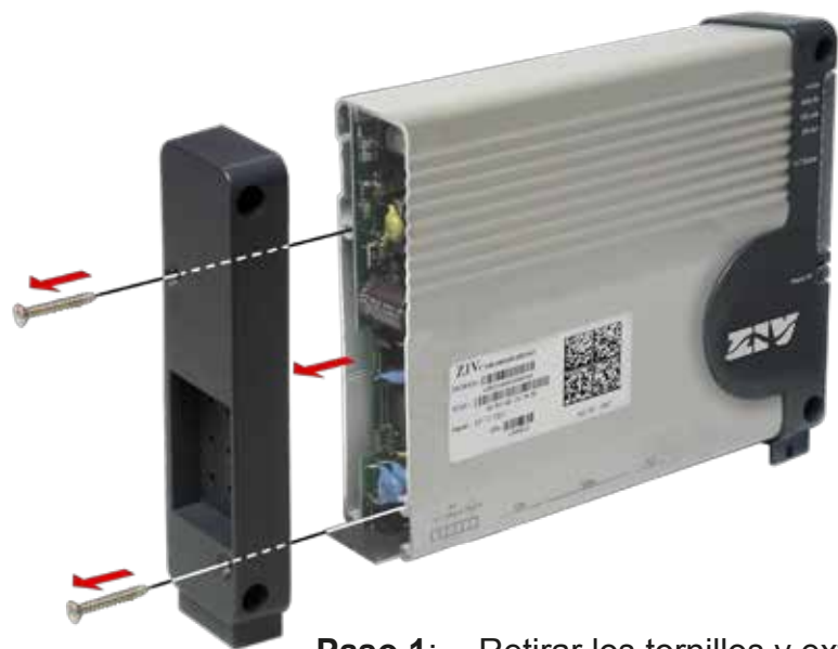
Paso 1: Retirar los tornillos y extraer la tapa posterior.
