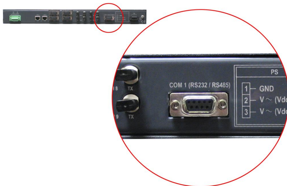
FIGURA 7 Disposición del conector COM1 en el panel CIC
