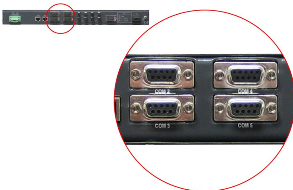
FIGURA 8 Ejemplo de disposición de conectores RS-232 adicionales (SUB-D) en el panel CIC
