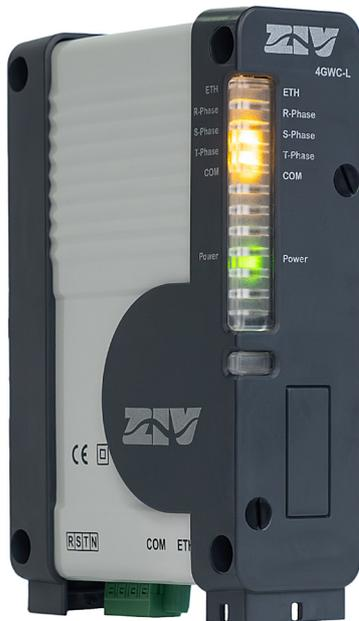
Un Gateway o modem PLC trifásico con tecnología propia de ZIV según el protocolo Meters & More
