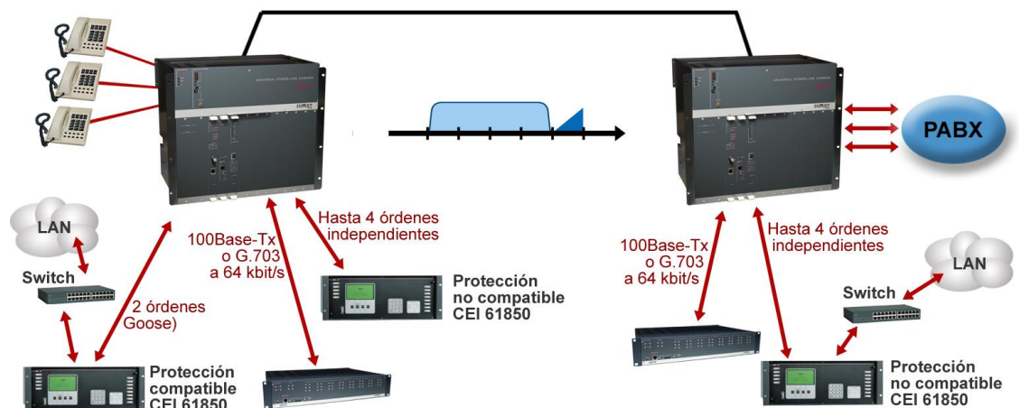
FIGURA 4 Transmisión de datos, voz y señales de teleprotección
