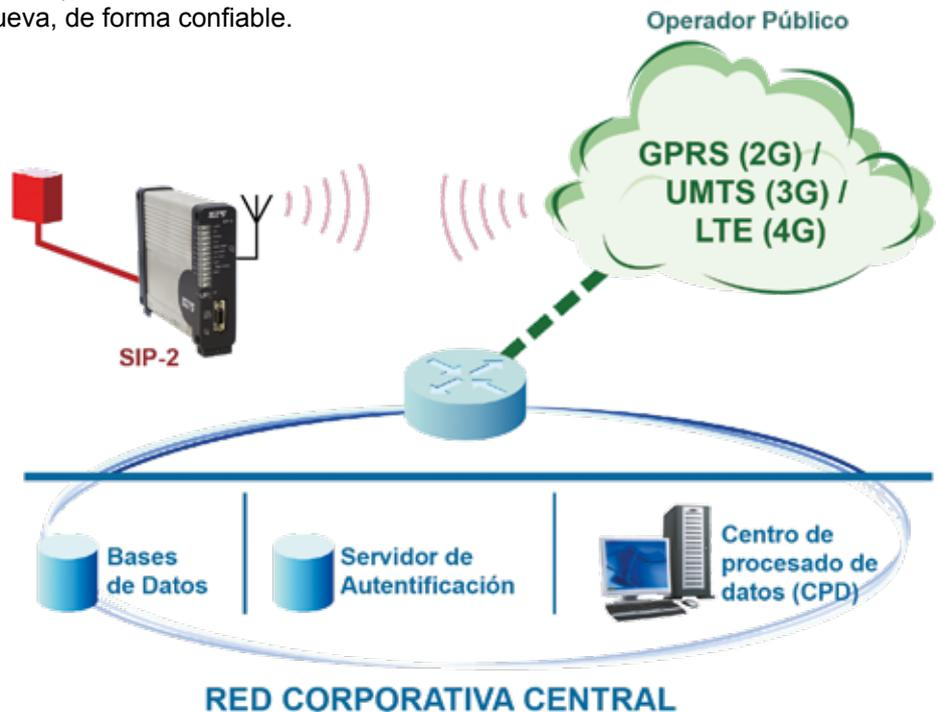
Como encapsulador, es capaz de transportar distintos protocolos serie permitiendo una fácil integración de dispositivos serie en una red IP segura.
