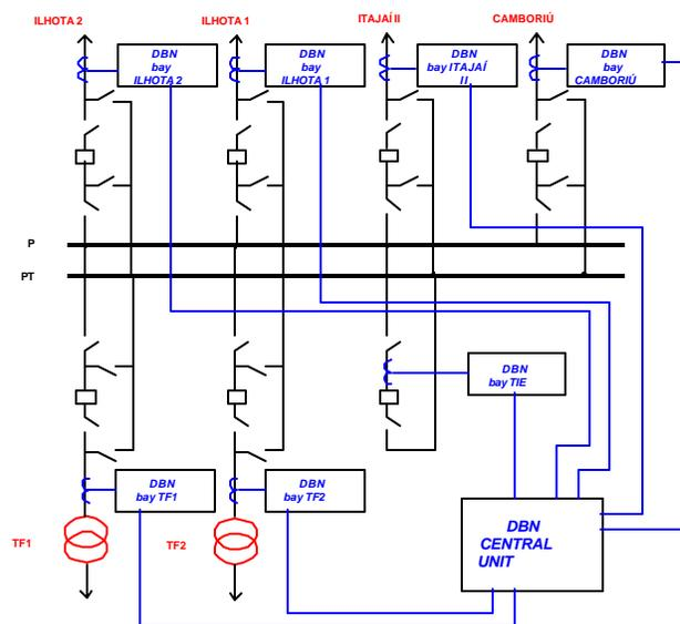
FIGURE 7 –Itajai Substation – 138kV Bus.
