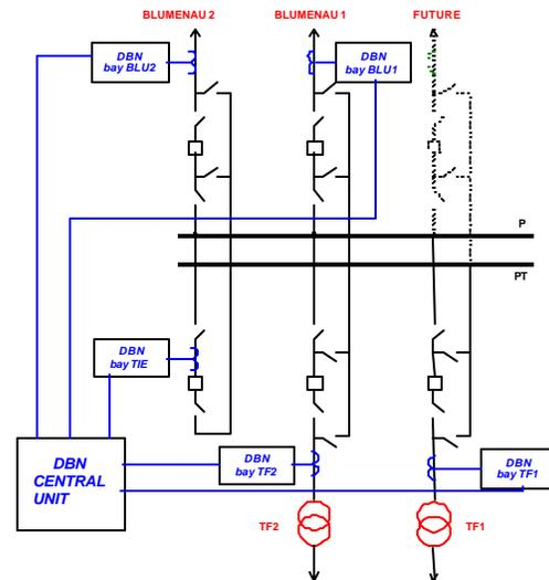
FIGURE 6 –Itajai Substation – 230kV Bus.
